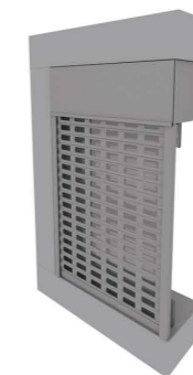
Накладной монтаж, короб внутрь
